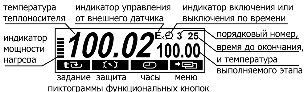
Рисунок 5 — Дисплей в режиме регулирования по программе
